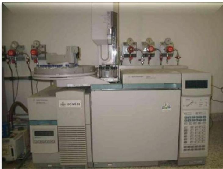
Figura 4.7 – Equipamento utilizado para as análises de compostos orgânicos voláteis.
