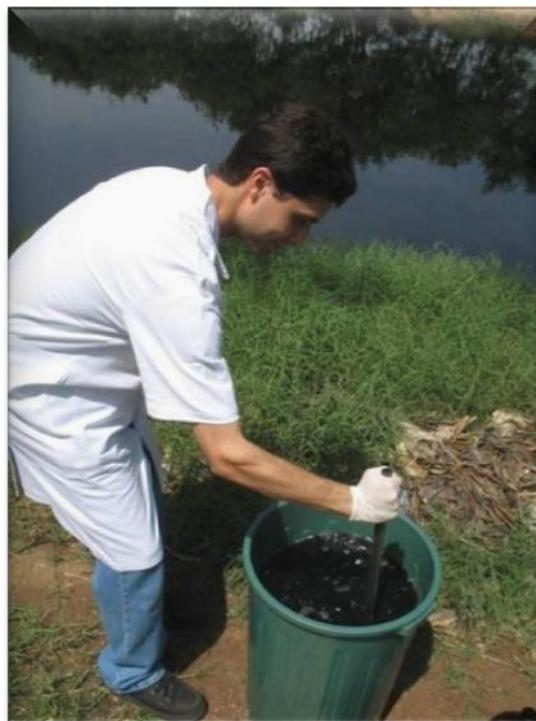
Figura 4.3 – Coleta e homogeneização da amostra de lixiviado bruto – Lagoa de Equalização do Aterro de Gramacho.
