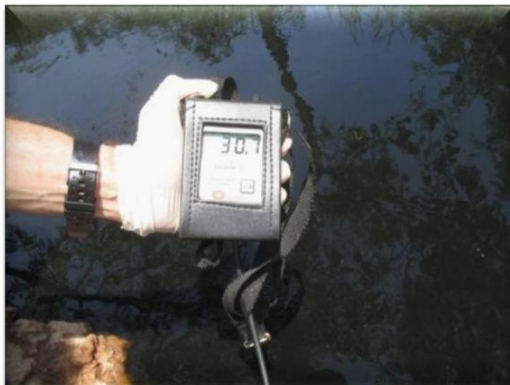
Figura 4.5 – Medição da temperatura no local de coleta.
