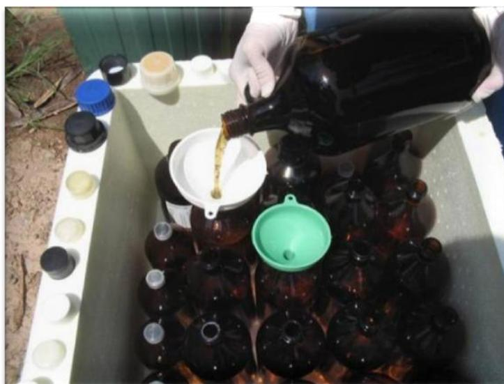
Figura 4.4 – Transferência do lixiviado para os frascos de armazenamento.
