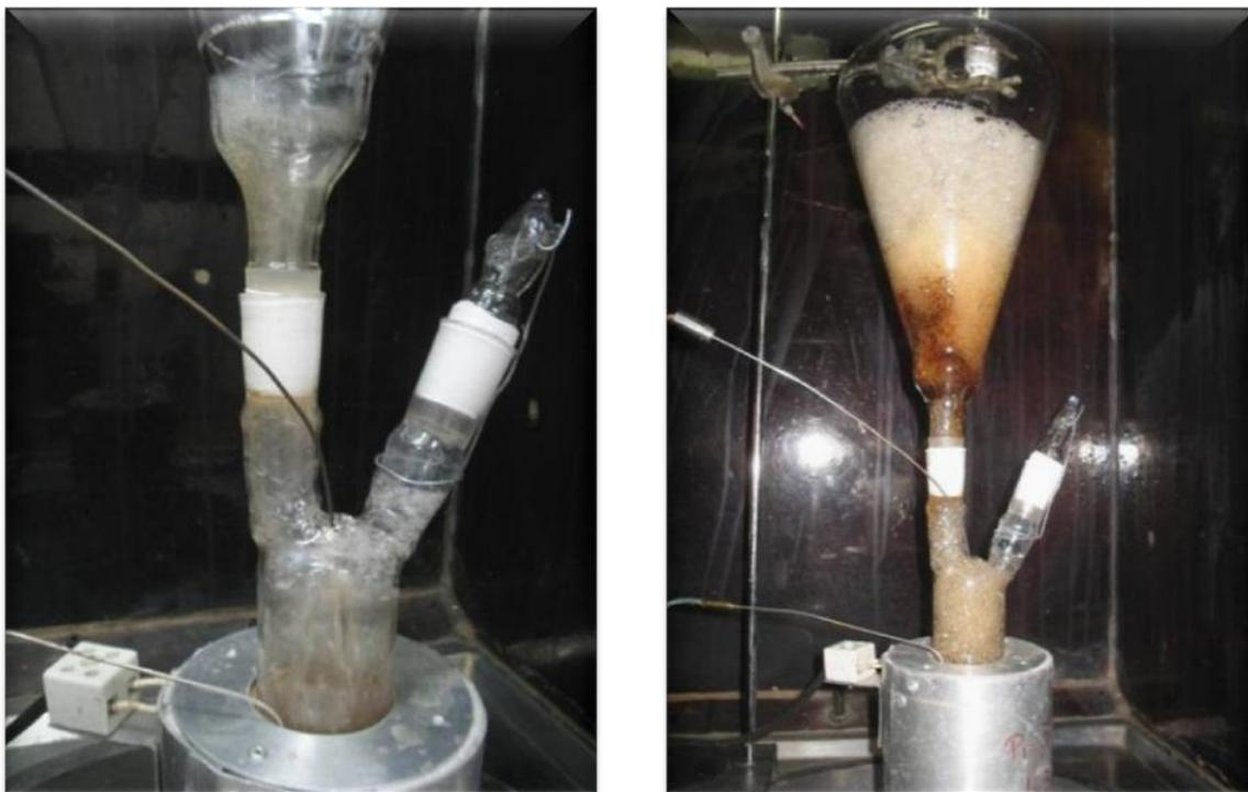
Figura 4.9 – Formação de espuma e refluxo durante a evaporação, com destaque para a adaptação do Erlenmeyer.
